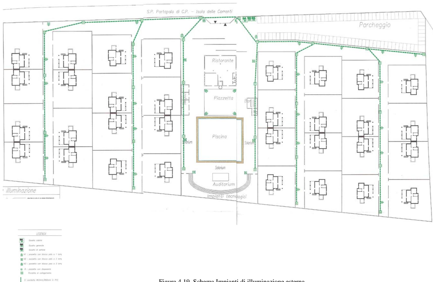
Figura 4.19. Schema Impianti di illuminazione esterna
